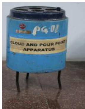
Fig. 10. Cloud and pour point measuring apparatus.
